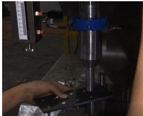
Gambar 8. Punch silinder bekerja
