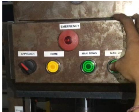
Gambar 9. Menaikkan punch silinder
