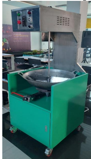
Gambar 6. Realisasi Mesin Pengaduk Sambal Bawang
