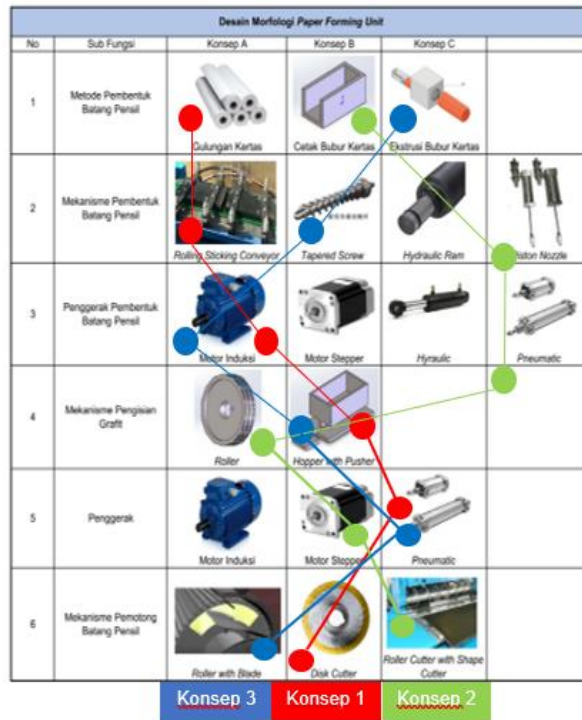
Gambar 3 Desain Morfologi Forming Unit
