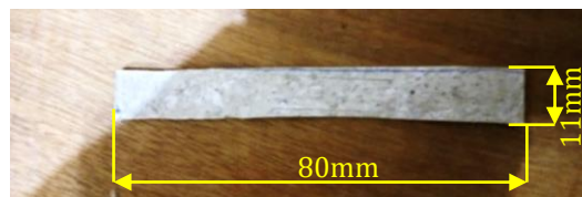
Gambar 7 Ukuran dan Bentuk Spesimen untuk Impact Test
