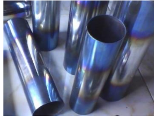
Gambar 5 Pipa Silencer Knalpot
