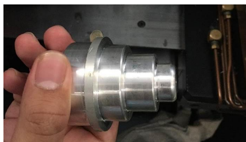
Gambar 5. Benda kerja hasil uji penyayatan
