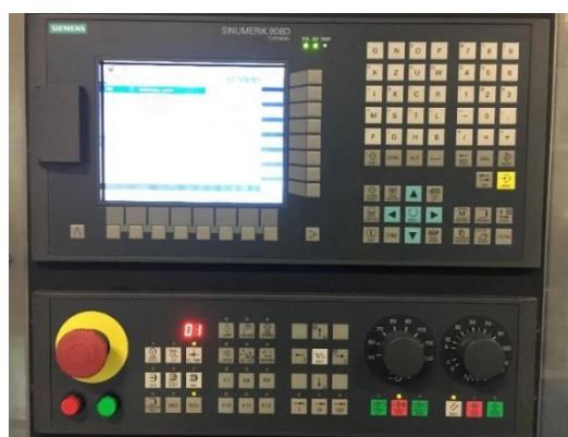
Gambar 1. Controller Sinumerik 808D
