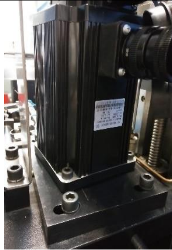
Gambar 4: Motor Spindle telah terpasang pada Mesin CNC Edu-Mill .
